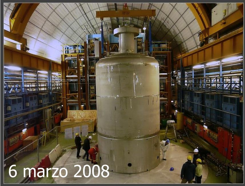
Realizzato in acciaio a basso livello di radioattività:
