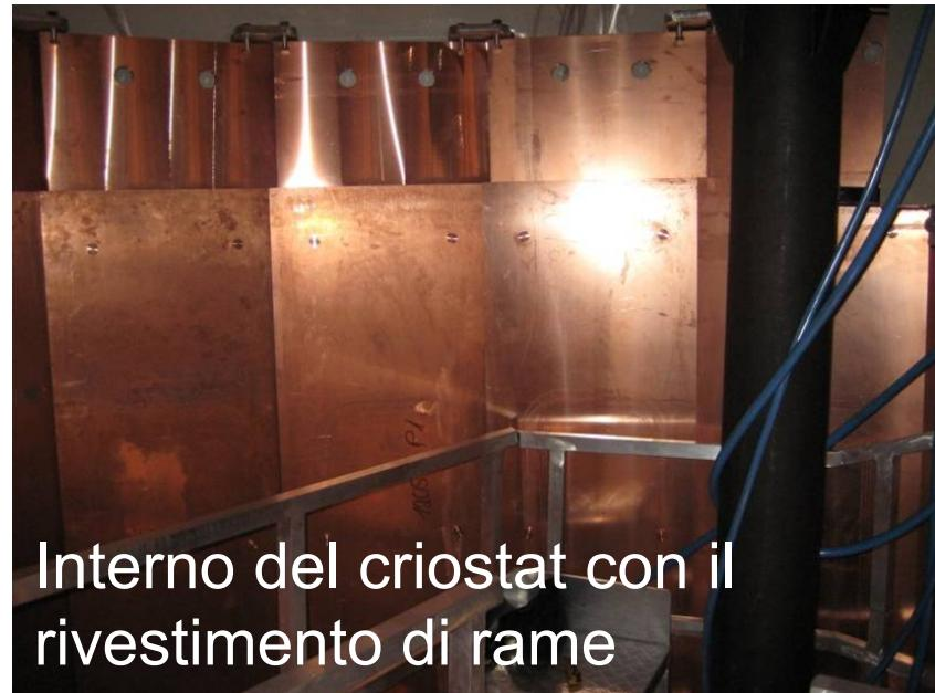
Interno del criostat con il rivestimento di rame
